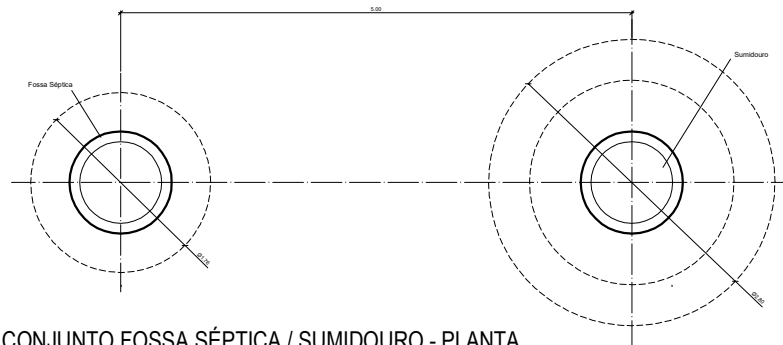
CONJUNTO FOSSA SÉPTICA / SUMIDOURO - PLANTA ESC.1:25
